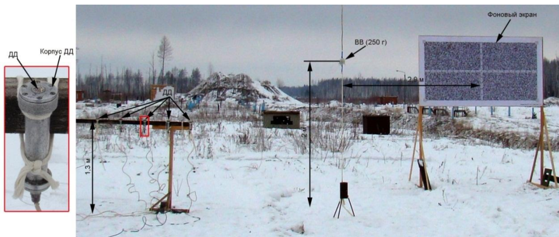
Рисунок 6. Расстановка оборудования на рабочем поле
