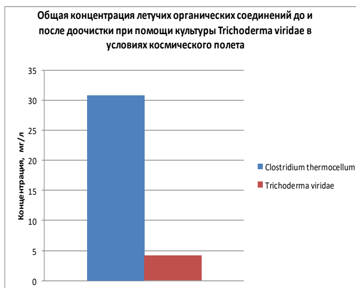
Рисунок 17. Общая концентрация летучих органических соединений до и после доочистки с помощью культуры Trichoderma viridae в условиях космического полета
